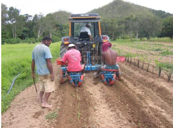
**photo n° 35: plantation mécanique avec une planteuse à pinces de type super prefer.**
